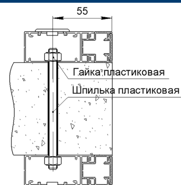
Рис. 6.5. Установка на внутреннюю алюминиевую раму
